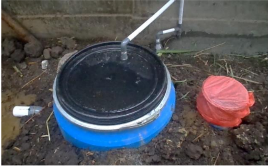
Gambar 2.3 Instalasi Produksi Biogas Sederhana
